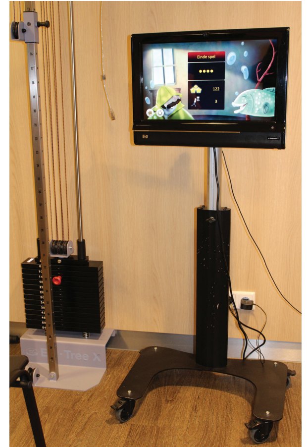
Abb. 1a: Der SilverFit Newton besteht aus einem PC mit Touchscreen und einen mobilen Ständer, und wird in Kombination mit einem Kraftgerät verwendet.
